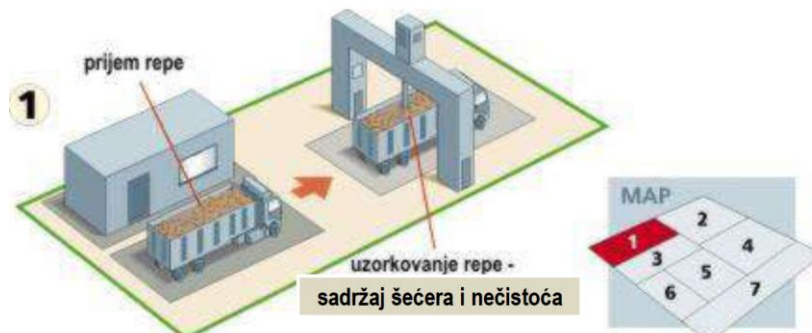
3D prikaz prve operacija u proizvodnji šećera (prijem i uzorkovanje repe)
